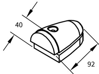
**Butée aluminium avec tampon sur ressort**
