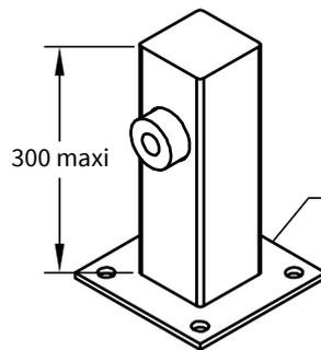
**Butée tube 50 x 50 potelet avec 2 tampons coniques**
