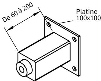
**Butée tube 50 x 50 potelet avec 1 tampon conique**
